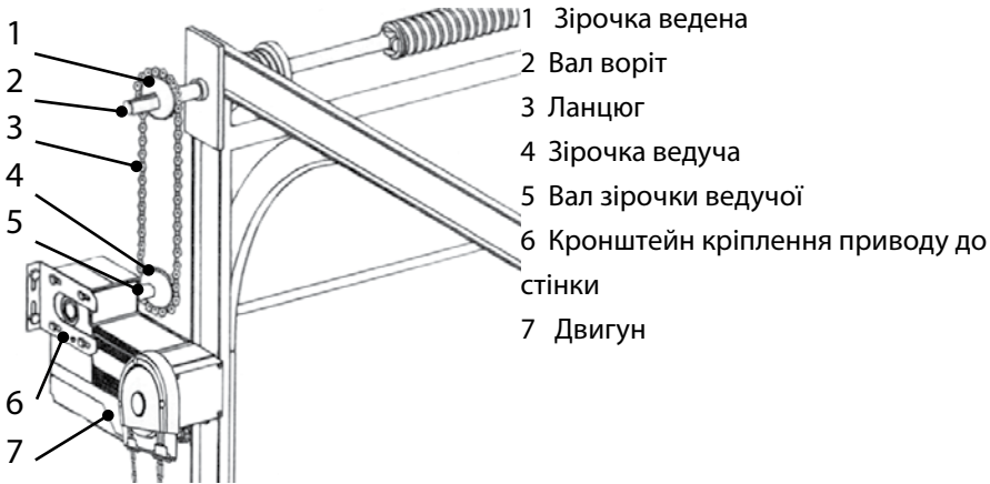
Рис.5 Схема встановлення двигуна на вал секційних воріт
